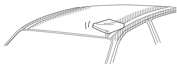
**1** Nettoyage de la zone d'installation sur le véhicule.
