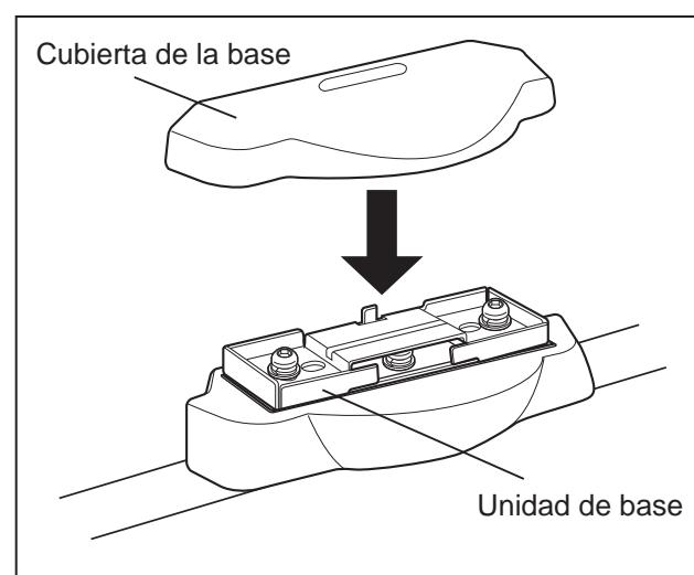
**1** Coloque la unidad de la base en la base del amortiguador / abrazadera de la base que se han instalado. Luego, con la llave hexagonal (incluida), sujetela ajustando de forma alternada los pernos derecho e izquierdo (cortos) [M6x15] (que se incluyen con el portacargas) hasta que los pernos estén bien firmes.
