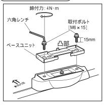
取付けたクッションベース・ベースブラケットの上にベースユニットを置き、キャリア本体付属の取付ボルト[M6x15]を六角レンチで交互に固くなるまで締付けます。
