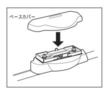
ベースキャリアを取外した際、付属のベース カバーを取付けて〈ださい。
