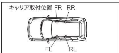
**4** クッションベースを車両の4ヶ所のキャリア取付部に載せます。
