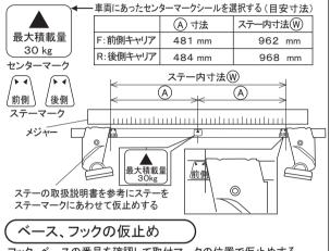
フック、ベースの番号を確認して取付マークの位置で仮止めする。 再度ステー内寸法をメジャーを使って確認する。
